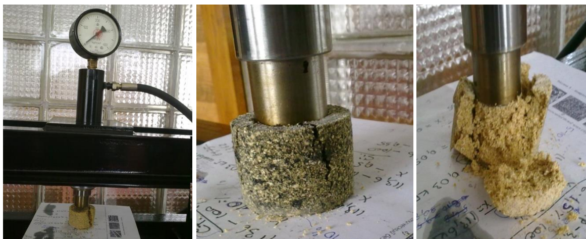
Рисунок 1 – Технологічний процес випробувань на характеристики міцності зразків з відходів деревообробного виробництва
