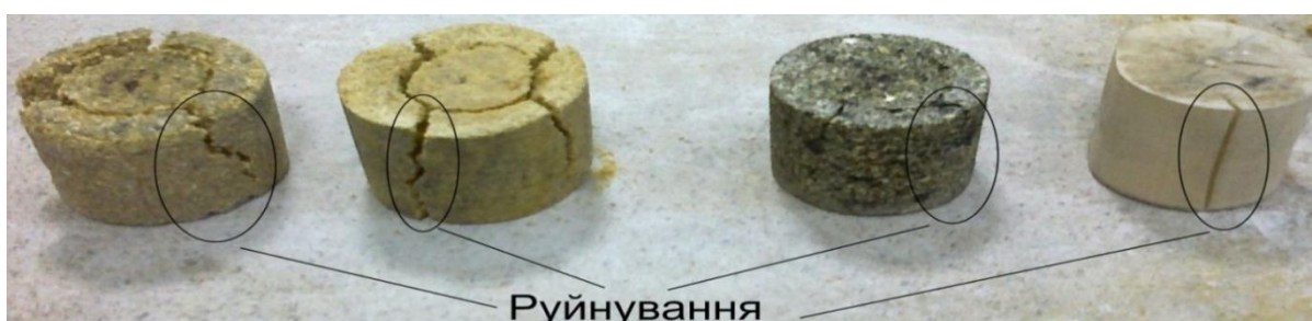
Рисунок 2 – Загальний вигляд зруйнованих зразків з відходів деревообробного виробництва в залежності від виду матеріалу, що пов'язує
