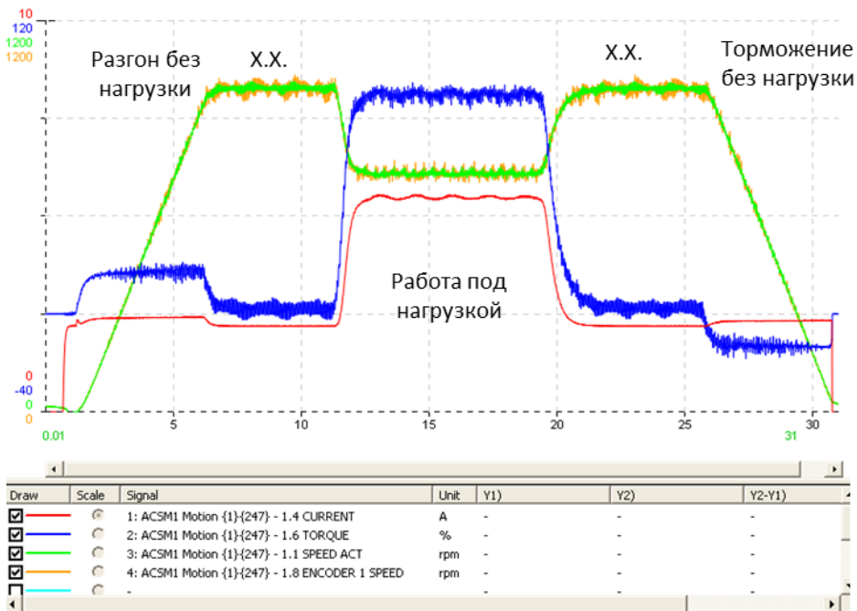
Рис. 5. Режим DTC с коэффициентом усиления пропорционального звена K_p=5 .
