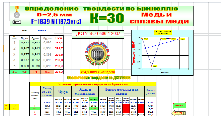
Рисунок 1. – Визначення твердості сплаву БрБ2 по Бринеллю
