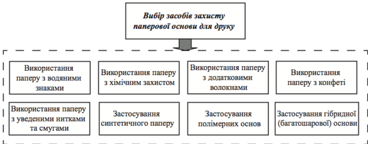
Рис. 1. Схема вибору виду захисту паперової основи для друку
