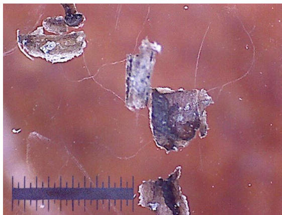
Рис. 4 Оптична мікроскопія сухої біомаси магнітної фази печериці (шкала лінійки 100 мкм)
