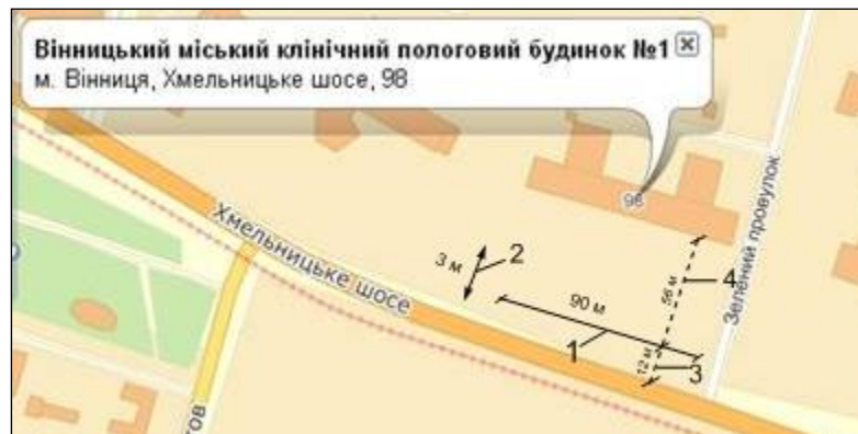
Рис. 5. Схема розташування шумозахисного екрану-стілки: 1 – шумозахисний екран-стілка, довжиною L=90 м; 2 – висота екрана-стілки h=3 м; 3 – відстань від смуги руху проїзної частини (джерела транспортного шуму) до екрану-стілки, l_1=12 м; 4 – відстань від екрану-стілки до будівлі пологового відділення, l_2=56 м.
